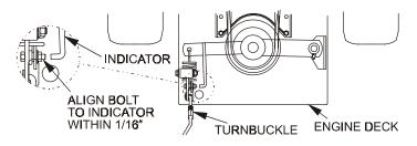
FIG. 15 BLADE ENGAGEMENT LINKAGE
